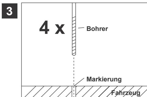
Legen Sie dann den Verstärker beiseite und bohren dann die Löcher für die Fixierschrauben an den zuvor markierten Punkten. Vergewissern Sie sich zuvor, dass keine Kabel, Leitungen und andere Komponenten des Fahrzeugs beim Bohren beschädigt werden. Alternativ können Sie auch (je nach Untergrund) selbstschneidende Gewindeschrauben verwenden.
