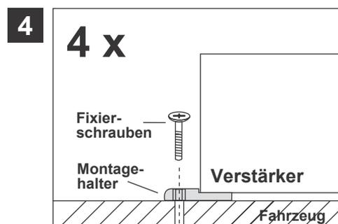
Halten Sie dann den Verstärker wieder an die zuvor gewählte Position und verschrauben dann den Verstärker an den vier noch freien Öffnungen der Montagehalter mit geeigneten Schrauben an den zuvor gebohrten Bohrlöchern am Fahrzeug. Achten Sie darauf, dass der verschraubte Verstärker fest sitzt und sich während der Fahrt nicht losvibriert.
