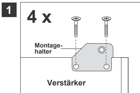
Vor dem Anbringen der Montagehalter sollten Sie zunächst die beiden Guss-Endteile an jedem Ende abschrauben. Montieren Sie dann die 4 beiliegenden Montagehalter an die Unterseite des Verstärkers mit den beiliegenden Schrauben und achten Sie darauf, dass die angewinkelte Seite des Montagehalters nach innen zeigt. Die vorgebohrten Gewindelöcher für die Montagehalter finden Sie jeweils an den vier Ecken des Verstärkers.
